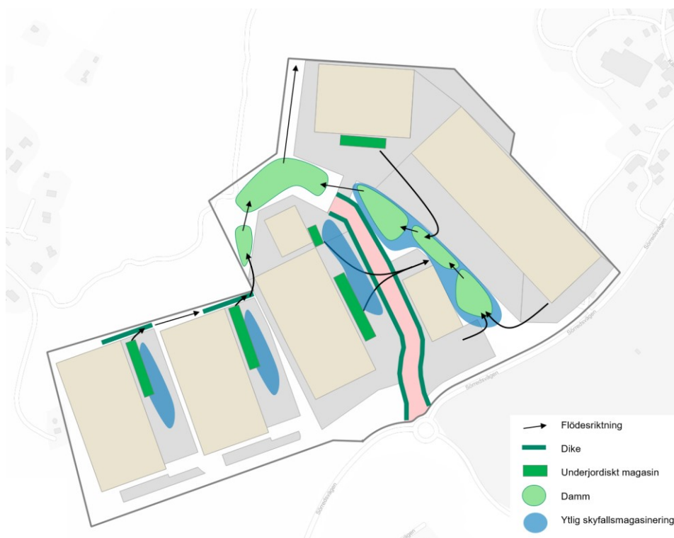
Figur 25 Principskiss över hur dagvatten och skyfallsanläggningar kan placeras för att möjliggöra erforderlig rening och fördröjning.
